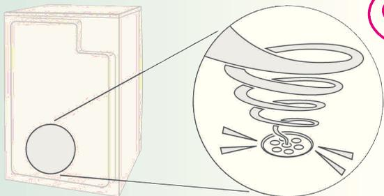
L'eau de condensation est évacuée par une pompe vers le réservoir d'eau de condensation, d'où des bruits de pompage.
