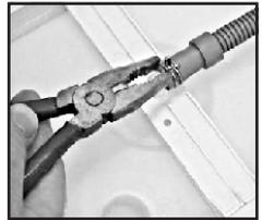
8. Glissez le tuyau de vidange par l'orifice de l'armoire.
