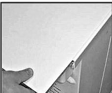
6. Retirez le couvercle du réservoir de l'arrière de la machine en dévissant les deux vis et en dépliant le couvercle.
