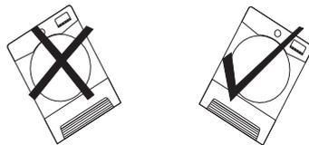
**Attention :** Si le produit est transporté différemment, attendez au moins 4 heures avant d'allumer l'appareil, ceci afin que le gaz liquide retourne dans le compresseur. En cas de non respect de cette procédure, le compresseur pourrait être endommagé.
