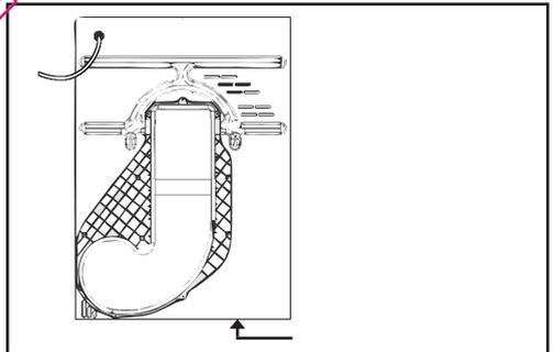
**Important :** Pendant le transport, l'appareil doit être stocké dans sa position normale d'utilisation. Si nécessaire, l'appareil peut être incliné comme montré ci-dessous.
