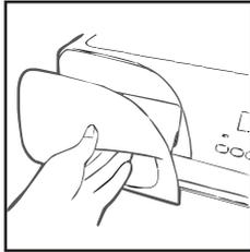
2. Inclinez le réservoir d'eau pour vidanger l'eau par le trou arrière. Une fois vidé, remettez le réservoir d'eau dans sa position d'origine. **POUSSEZ - LE FERMEMENT EN PLACE.**
