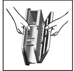
3. Retirez doucement la poussière ou les peluches avec un chiffon. Ne pas utiliser d'eau pour nettoyer le condenseur.
