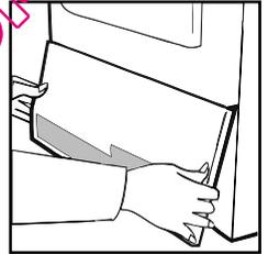
2. Tirez fermement sur la poignée et faites glisser le réservoir d'eau en dehors du sèche-linge.
