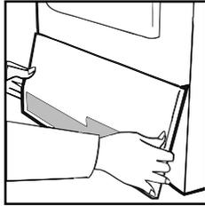
2. Tournez les deux leviers de blocage dans le sens contraire des aiguilles d'une montre et retirez le condenseur.
