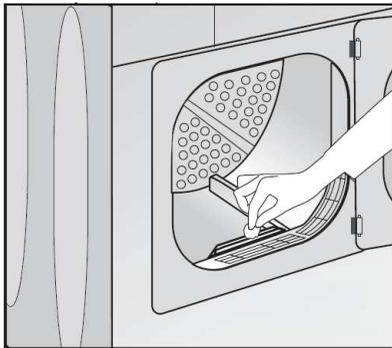
Pour nettoyer les capteurs d'humidité :
