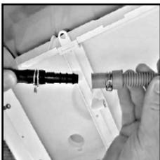
5. Fixez le tuyau noir du kit (en utilisant le connecteur et les étriers de tuyau fournis) au tuyau démonté du raccord.
