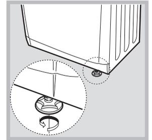
Après avoir installé le sèche-linge dans sa position définitive, contrôler s'il est placé de niveau dans le sens de la largeur dans un premier temps et ensuite sur la profondeur. Si le sèche-linge n'est pas de niveau, régler les deux pieds avant jusqu'à atteindre une position adéquate.
