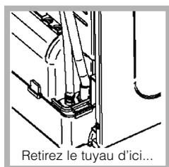
Retirer le tuyau de l'endroit présenté (voir schéma).
