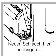
! Sicherstellen, dass der Schlauch nicht zusammengedrückt wird oder Knickstellen bekommt, wenn sich der Wäschetrockner an seinem vorgesehenen Standort befindet.
