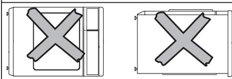
⚠ Si le transport n'a pas été effectué conformément à cette description, il faut impérativement respecter un temps de repos d'1 heure avant de raccorder le sèche-linge électriquement. Sinon la pompe de chaleur pourrait être endommagée !
